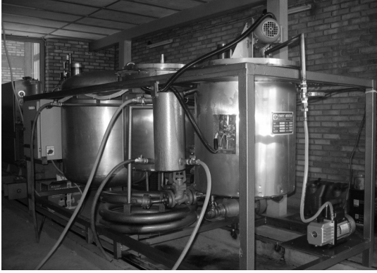
Şekil 1. Atık yağ geri dönüşüm sistemi.
