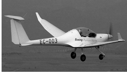
Şekil 4. İlk insanlı hidrojen yakıtlı uçuş testi [7]
