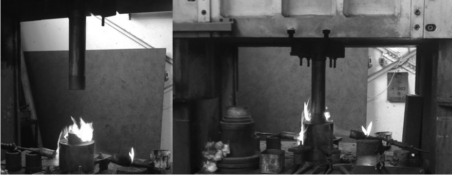
Şekil-7: Pres yardımıyla içi dolu silindirden içi boş kap şeklinde silindir elde edilmesi
