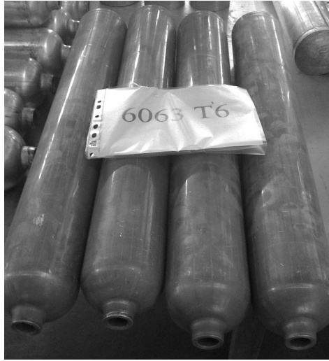
Şekil-14: Hidrostatik basınç testine tabi tutulacak numuneler
