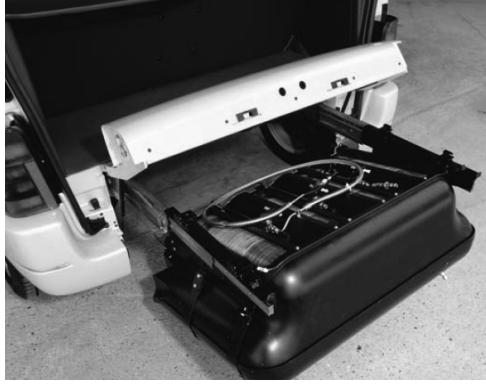
Şekil-5 Peugeot Partner' de yüksek basınçlı hidrojen tanklarının yerleşimi [3]
