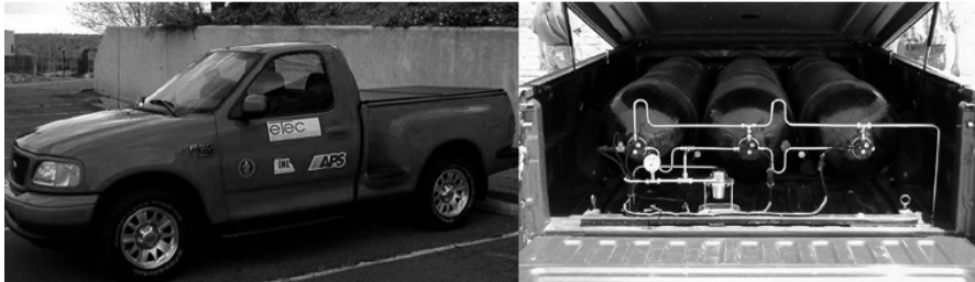
Őekil-4: Bir kamyonet kasasında kompozit hidrojen tanklarının muhafaza edilmesi [2]
