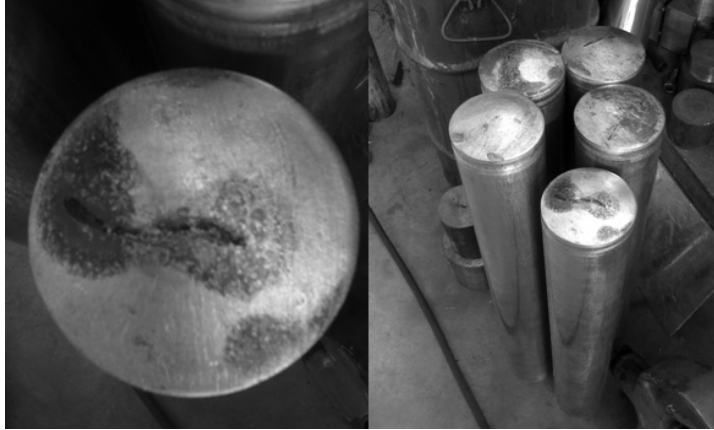
Şekil-12: Çatlak-iç boşluklar
